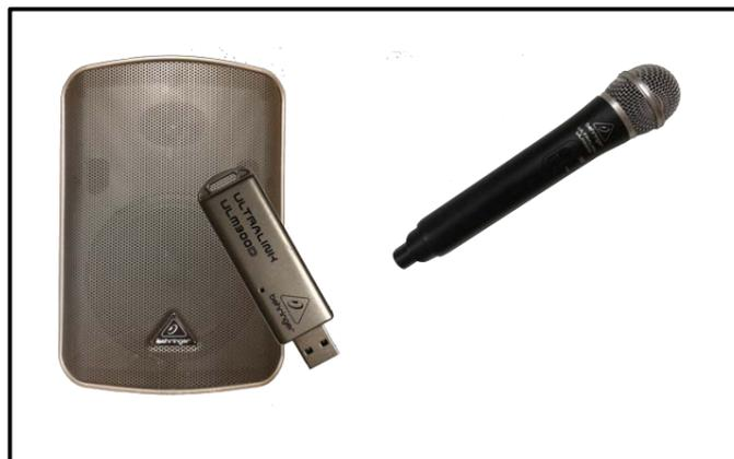
**9. USB Stick in PA einstecken und Funkmikrofon einschalten.**
