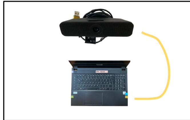
**6. Webcam anschließen** (gelbe Markierung) **und an geeigneter Stelle, möglichst weit oben anbringen.**
