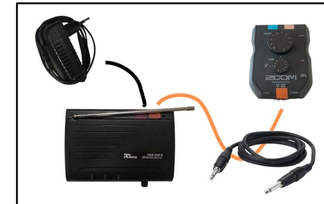
**8. Funkmikro Empfänger an Strom anschließen, über Audio Kabel Klinke mit Audio Interface verbinden.** (orange Markierung)
