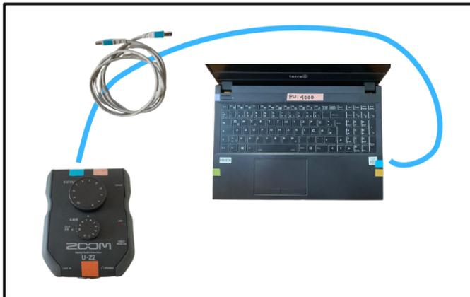
**7. Audio Interface mit USB Kabel an den Laptop anschließen.** (blaue Markierung).
