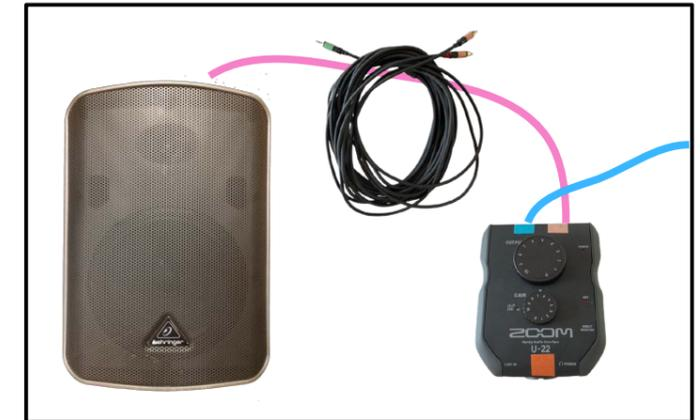
**8. PA einschalten und Eingang mit Audio Kabel Klinke-Cinch mit Audio Interface Ausgang verbinden** (rosa-grüne Markierung).
