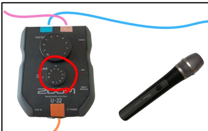
**11. Für Soundcheck ins Mikrofon sprechen und Eingangssignal prüfen.** (bei grünem Licht alles in Ordnung bei rotem Licht Übersteuerung → Gainregler runterdrehen)
