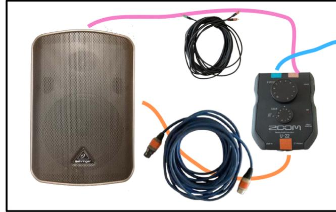
**10. PA Ausgang mit Audio Kabel XLR (orange Markierung) mit Audio Interface Eingang verbinden.**
