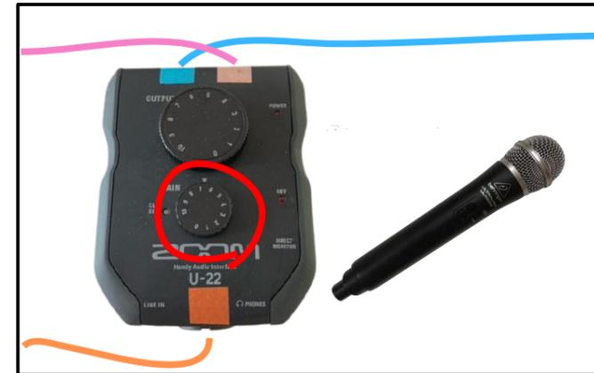
**11. Für Soundcheck ins Mikrofon sprechen und Eingangssignal prüfen.** (bei grünem Licht ist alles in Ordnung, bei rotem Licht gibt es eine Übersteuerung → Gainregler runterdrehen)
